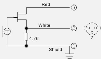
E101DXLR Wiring Diagram
