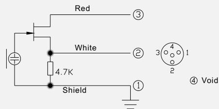
E101TQG Wiring Diagram
