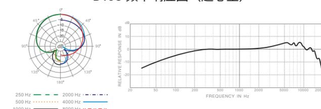
D10D 频率响应图 (超心型)
